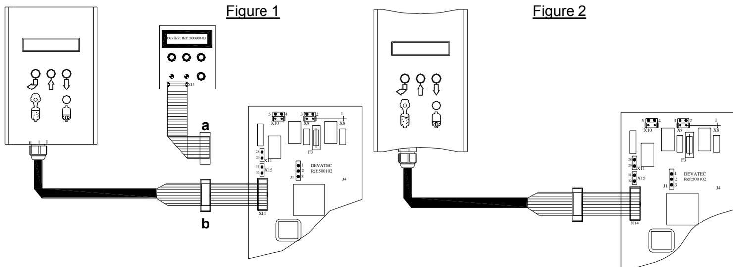
Pour raccorder le coffret déporté avec les appareils de la gamme RTH & MC2, veuillez procéder comme sur la figure 1, vous avez la possibilité de conserver l'affichage de l'humidificateur en raccordant la prise femelle « a » sur la prise male « b ».
