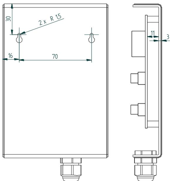
Pour fixer le coffret déporté, utilisez un système de fixation en fonction du matériau support.
