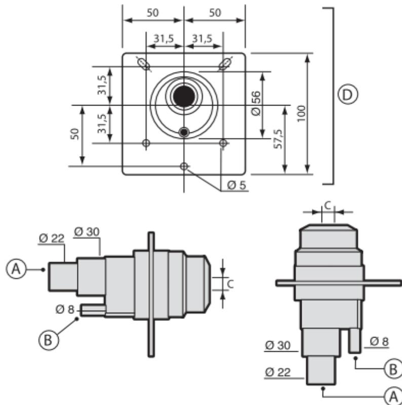
La buse peut être montée en axe horizontal ou vertical (orifice vers le haut).
